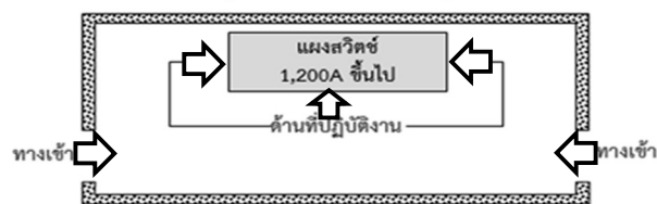
รูปที่ 8.8 แสดงทางเข้าไปยังพื้นที่ว่างเพื่อปฏิบัติงานทั้ง 2 ข้างของแผงสวิตช์
